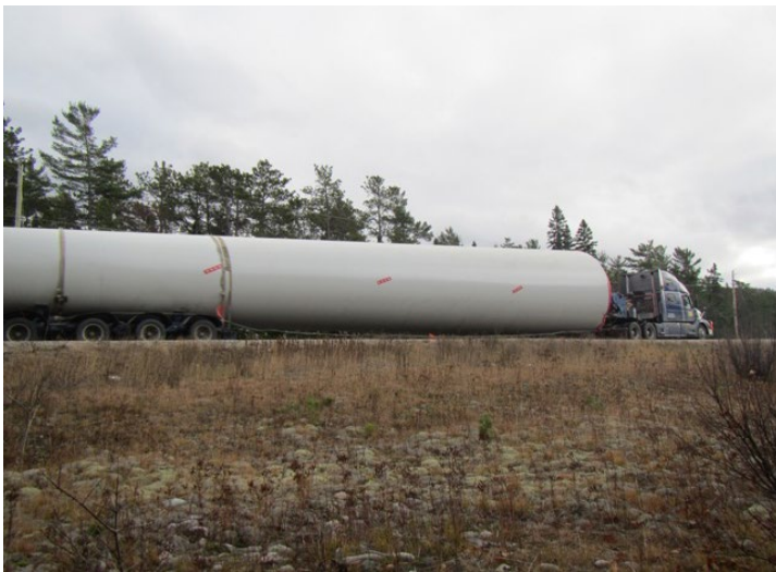
Entrega de Equipos. Los componentes de la turbina, incluyendo la torre, las paletas (aspas?) de viento y la góndola, se entregan en el sitio.
